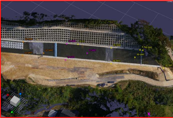
3次元起工測量 ⇒先行工事である切土工事の竣工データを活用することで、作業の省力化とコスト縮減を図った。
